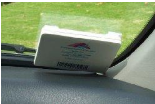
Etiqueta RFID empleada para la recaudación con peaje electrónico en las carreteras
